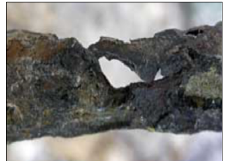
Abb. 2: Lochfrass an einem Armierungseisen.
