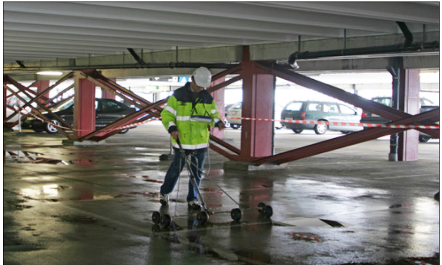
Abb. 4: Potentialmessung mit 4 Radelektroden.
